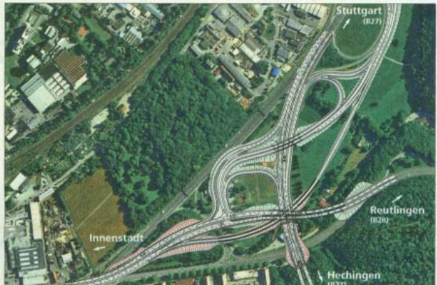
Fahrtstreifen, Auffahrten und Rampen ohne Ende – der Entwurf des Regierungspräsidiums für den Verkehrsknoten am Französischen Viertel (oben) schockierte viele Tübinger. Der neue in Bürgerbeteiligung entstandene Entwurf (unten) zerschneidet das Neckartal weit weniger, erfordert aber eine neue Lärmschutzplanung entlang der B28. Grafiken: Eck
