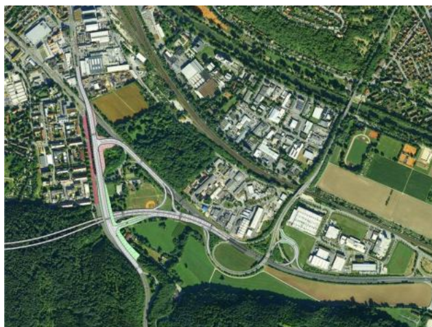
Die Variante mit dem sogenannten Zweifachanschluss im Tübinger Norden überzeugte Bürger und Verwaltung, weil dadurch viel Brückenbau vermieden wird. FOTO/REPRO: RP
